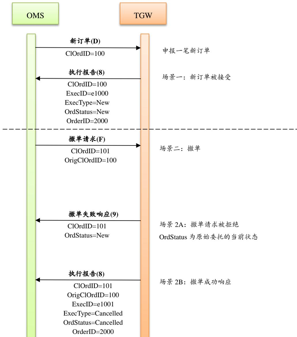
图 3-2 撤单请求消息流示意图
