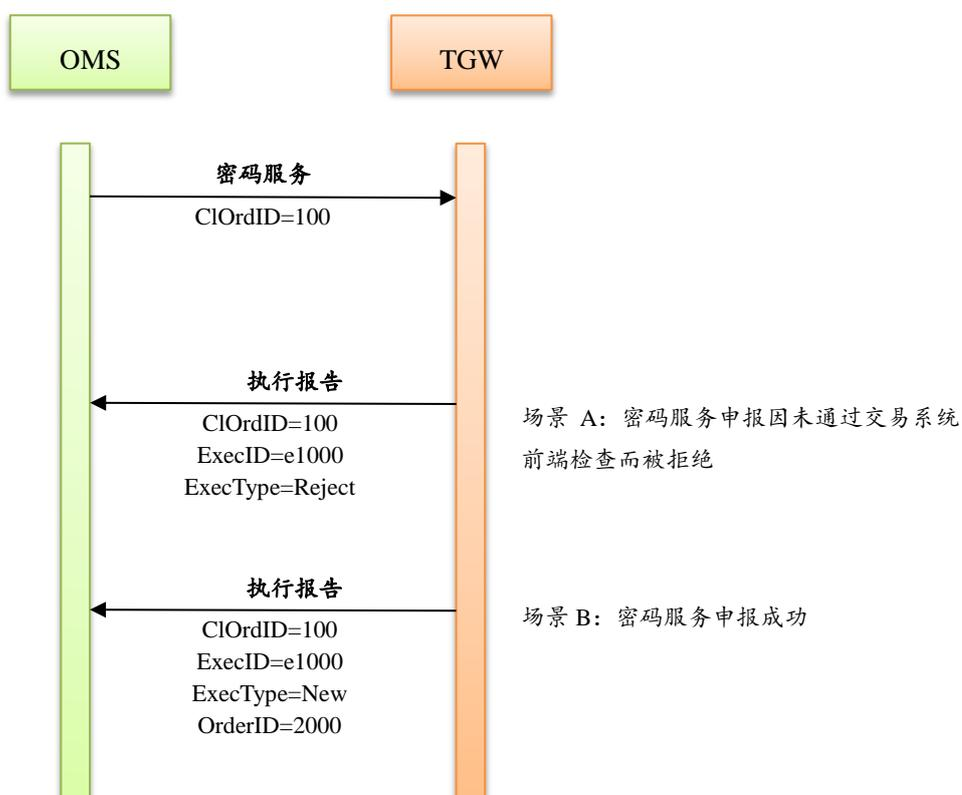
图 3-20 密码服务处理消息流示意图
