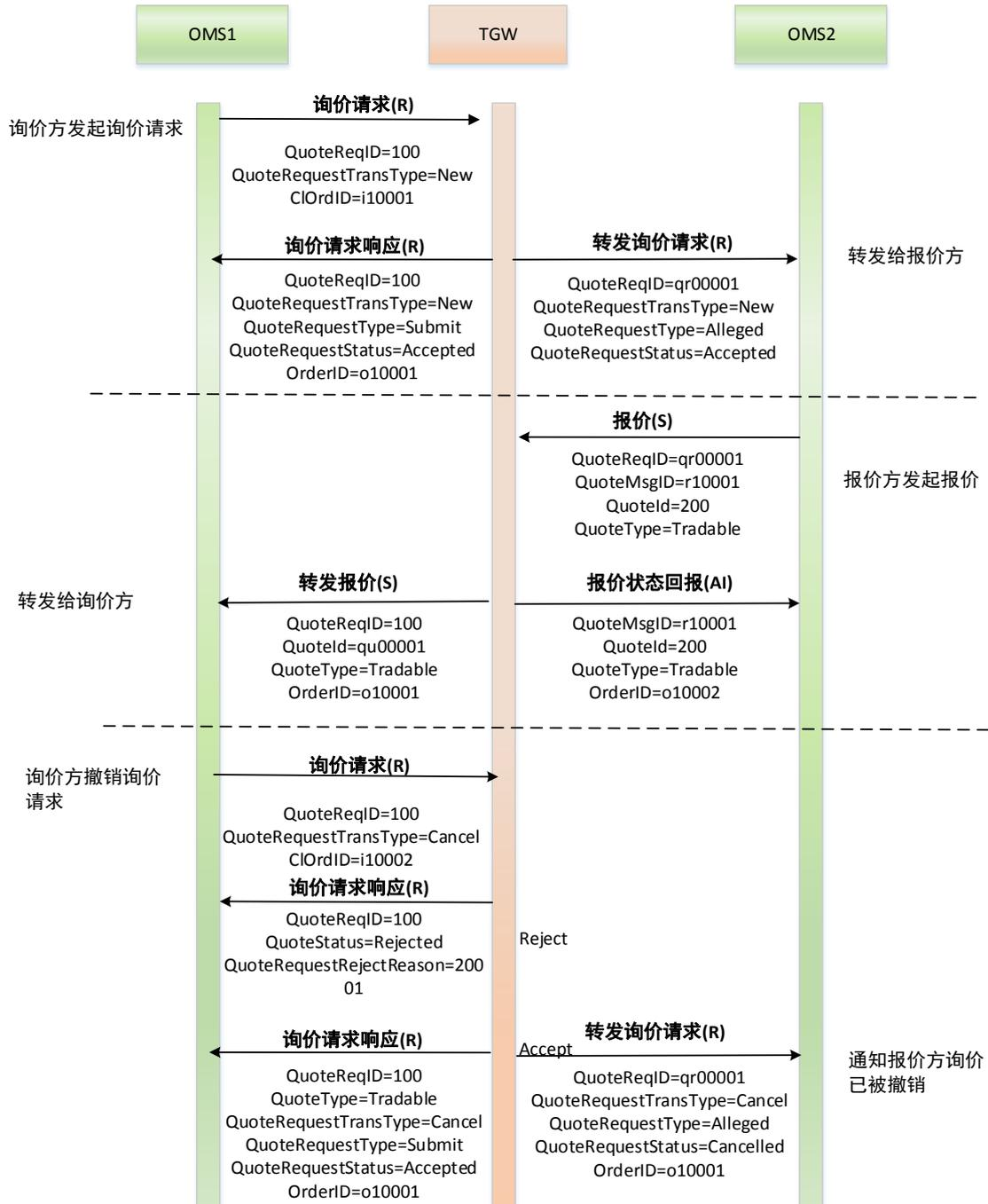
图 3-8 询价方撤销询价处理消息流示意图
