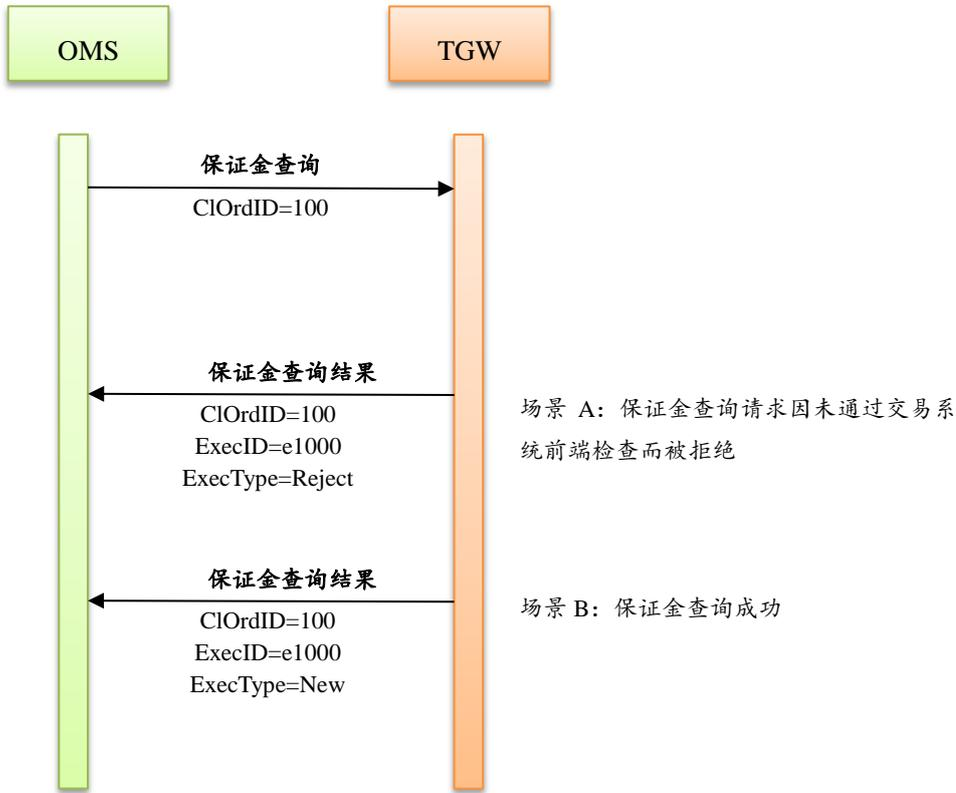
图 3-21 保证金查询处理消息流示意图
